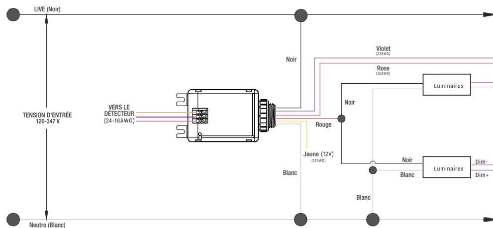
Lors du branchement de plusieurs luminaires, assurez-vous que la somme des courants de descente de gradation utilisés par tous les luminaires ne dépasse pas le courant de descente de gradation de cet appareil
