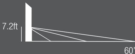
Le montage à 7,2 pieds au-dessus du sol permet une portée maximale. Si le capteur est installé au-dessus de cette distance, la portée utile est réduite.
