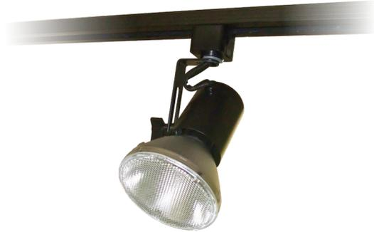
Le projecteur économique sur rail, à pivot latéral réglable, permet d'utiliser adéquatement plusieurs lampes incluant la PAR30 à collet long. Il offre un concept à demi étrier présentant une fente de réglage coulissante qui procure un maximum d'options de hauteurs du luminaire. Interrupteur arrêt/marche intégré et indicateur de polarité de rail inclus. Le modèle AL95 comprend un adaptateur de rail de style J et J2. Adapté pour montage sur rail au plafond.
