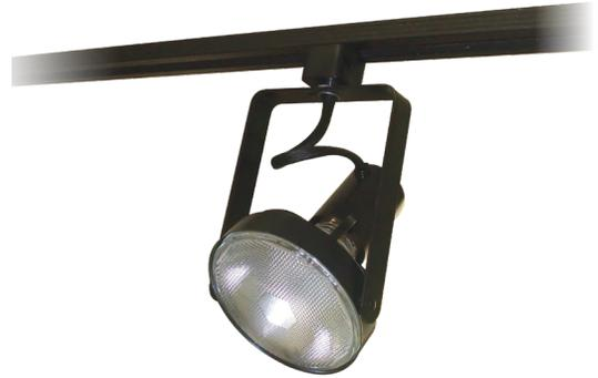
Projecteur à cardan sur rail économique à chargement de lampe frontal. Interrupteur arrêt/marche intégré et indicateur de polarité de rail inclus. Le modèle AG05N comprend un adaptateur de rail de style J et J2. Adaptateur de style H et H2 disponible sur demande. Adapté pour montage sur rail au plafond.
